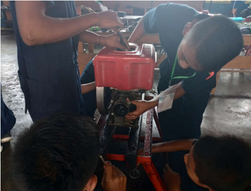
Gambar 18. Praktikum melepaskan tangki bahan bakar dari engine
