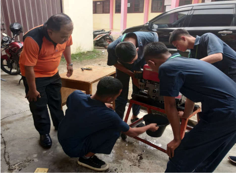
Gambar 17. Praktikum mengeluarkan oli dari engine
