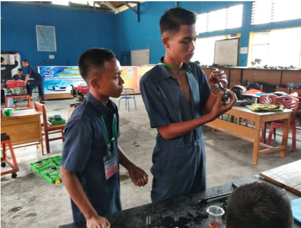
Gambar 10. Praktikum merakit komponen pompa injeksi engine diesel
