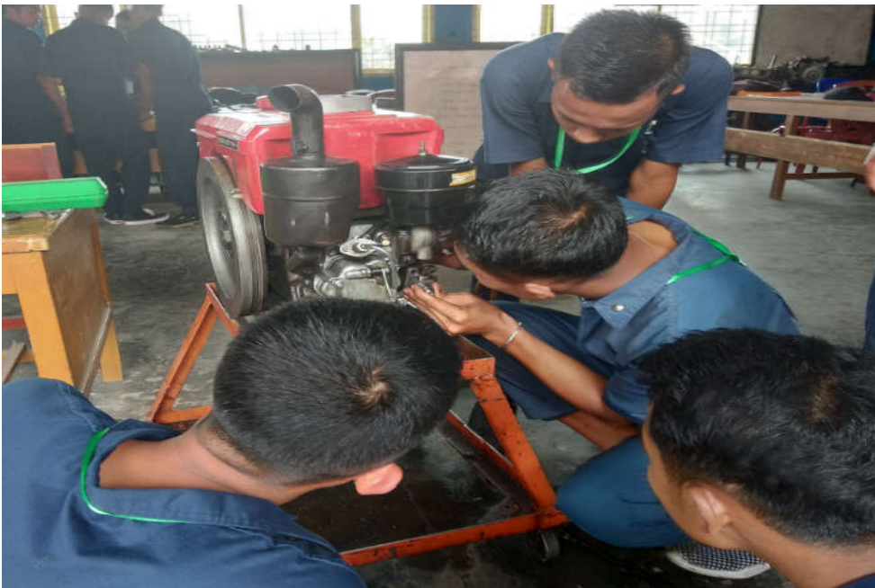
Gambar 14. Memasang pompa injeksi pada engine
