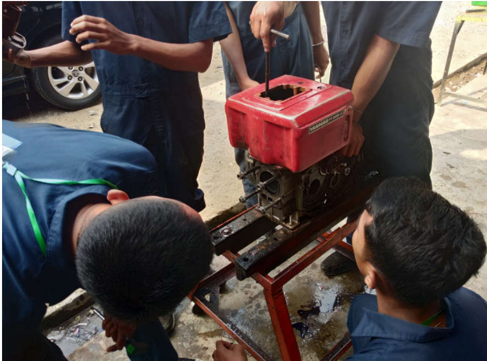
Gambar 19. Praktikum melepaskan radiator dari engine
